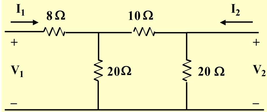
$$\begin{bmatrix} V_1 \\ V_2 \end{bmatrix} = \begin{bmatrix} 20 & 8 \\ 8 & 12 \end{bmatrix} \begin{bmatrix} I_1 \\ I_2 \end{bmatrix}$$
