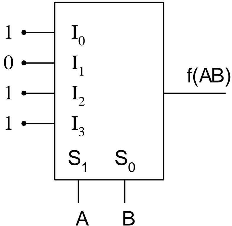
$$\overline{\overline{A}}\overline{\overline{B}} + \overline{A}\overline{B} + AB$$
