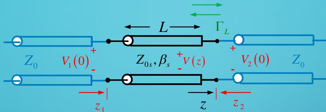
$$V_2^-(0) = V_2(0) = V(0) = V^+(0)(1 + \Gamma_L)$$
